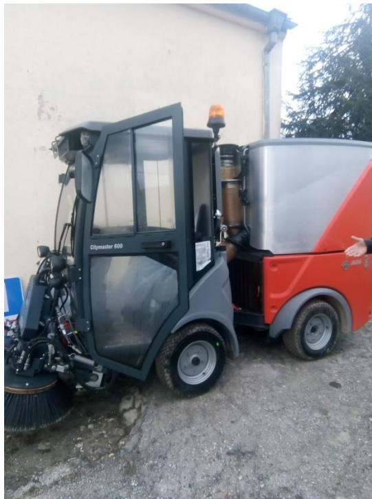
Снимка 1 Машина със сметосъбиращ бункер 600л. за машинно метене и миене на улици, събиране на листа, почистване на сняг и лугиране и косене на тревни площи
